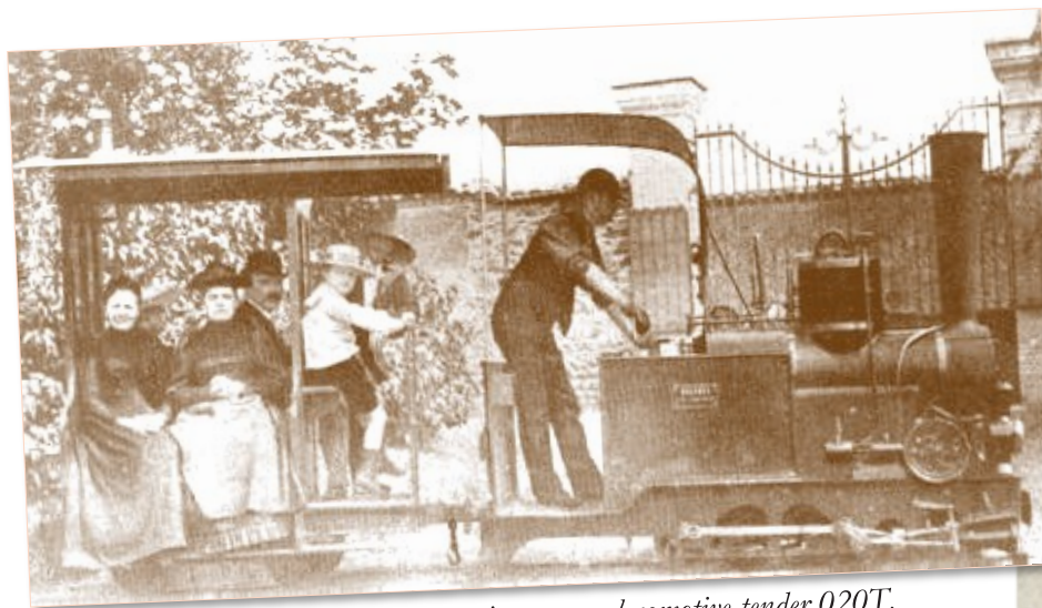
Le Colibri après transformation en une locomotive-tender 020T, à voie inférieure à un mètre - Archives Fondation Berliet, Lyon
